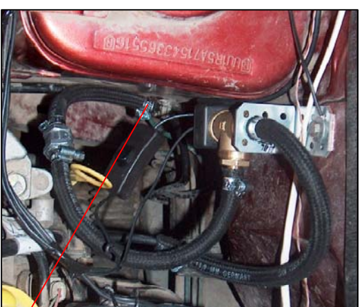
Colier fixare furtun pe conducta de plastic existenta, dupa sectionarea ei, partea dinspre rezervor
